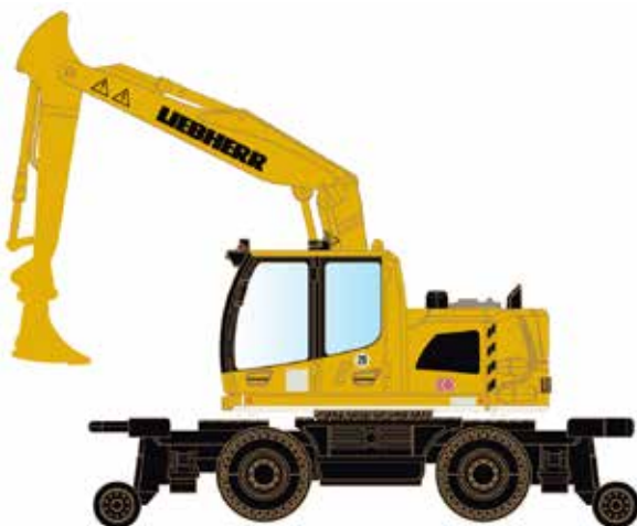
LC4270 ZWEIWEGE-BAGGER LIEBHERR A922 RAIL - DB BAHNBAU
